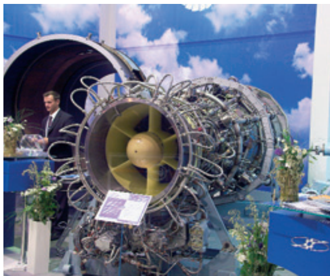
Фото 2. ГТУ-12П с правым вращением силовой турбины
