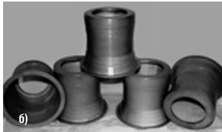
Фото 1. Диски первой ступени турбины (а) и крупногабаритные тонкостенные полые турбокомпрессорные валы (б) из гранул сплава ЭП741НП для двигателя РД33
