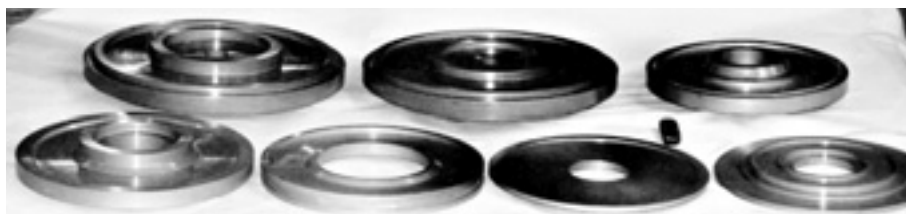
С Фото 2, табл. 2. Комплект заготовок дисков из гранул сплава ЭИ698П и их гарантируемый уровень механических характеристик для промышленных и судовых ГТД
