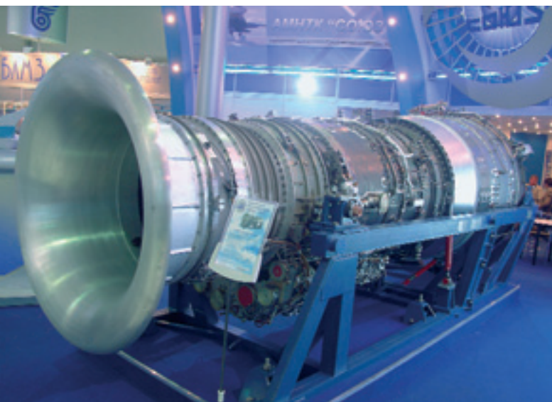
Фото 1. Газотурбинный привод ГТЭ-30-300 мощностью 30,5 МВт
