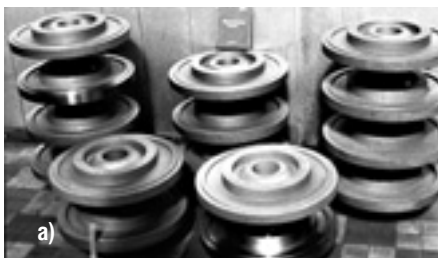
Фото 1. Диски первой ступени турбины (а) и крупногабаритные тонкостенные полые турбокомпрессорные валы (б) из гранул сплава ЭП741НП для двигателя РД33
