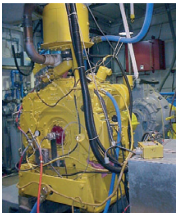
❶ Фото 2. Одноцилиндровый двигатель компании Caterpillar для отработки технологий по программе ARES
