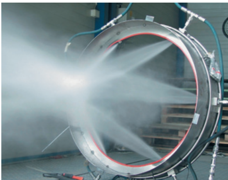
Фото 2. Периферическое размещение форсунок
