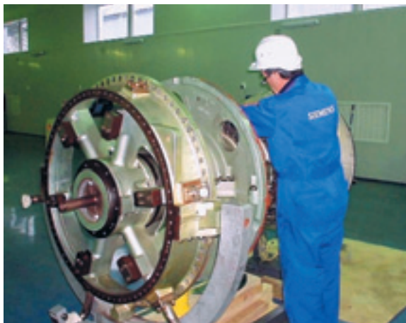
Фото. Проведение инспекции газовой турбины SGT-100 в Краснодарском сервисном центре
