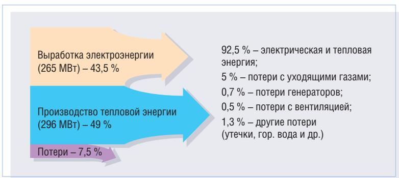
максимальная гибкость ПГУ-ТЭЦ в отношении изменения требуемой тепловой нагрузки при условии сохранения высокого полного КПД стала приоритетным критерием оптимизации тепловой схемы. Оптимизация проводилась, базируясь на коэффициенте  $\alpha$ , который равен отношению производимой на ПГУ-ТЭЦ электрической и тепловой энергии.
