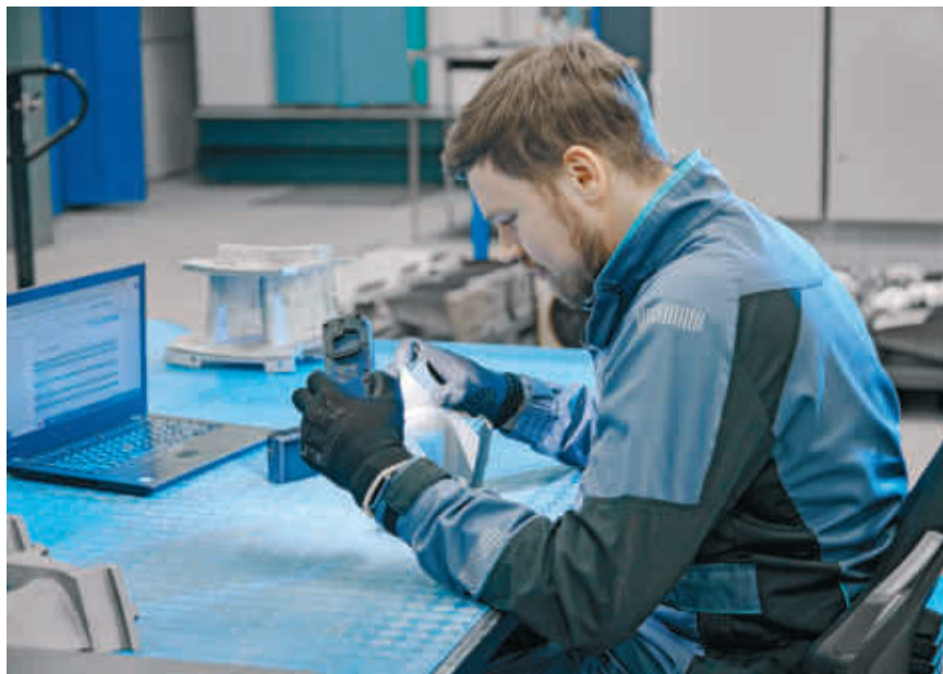
Рис. 2. Визуальный контроль деталей
