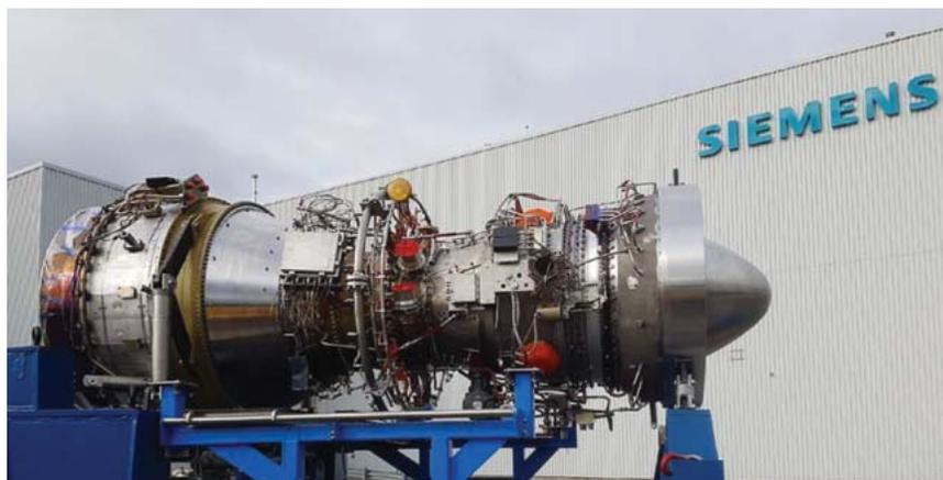
Фото 2. Газотурбинный двигатель SGT-A65 TR на испытательном стенде
