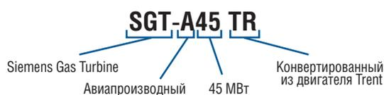
Рис. 4. Расшифровка наименования газотурбинного двигателя Siemens SGT-A45 TR
