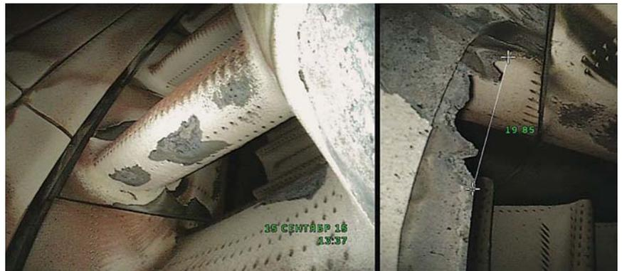
Фото 3. Повреждения модифицированной сопловой лопатки
