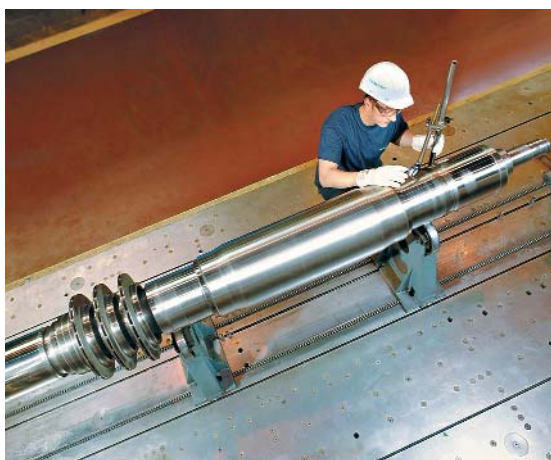
С Единый монолитный вал электродвигателя и компрессора
