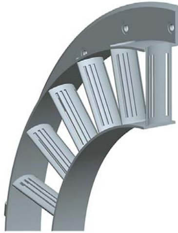
➤ Рис. 7. Кольцевая камера для подвода пара контура НД в турбине Т-40/50-8,8
