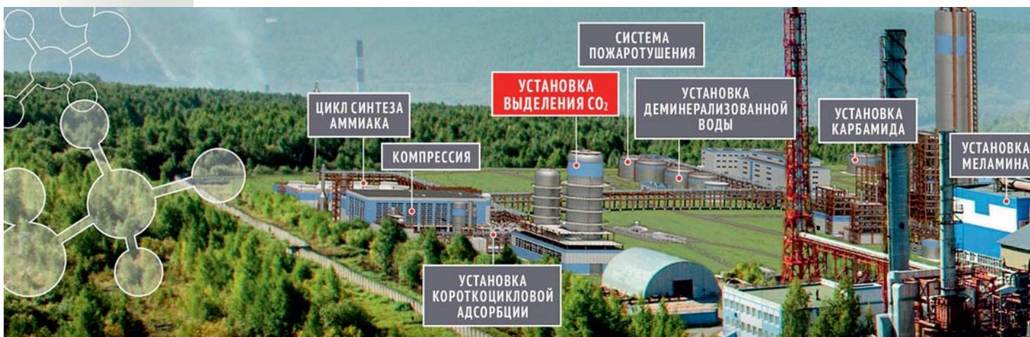
Из дымовых газов оборудования по синтезу метанола установка будет ежедневно извлекать до 1 120 тонн CO<sub>2</sub> (эквивалент сжигания около 450 тыс. литров автомобильного топлива)
