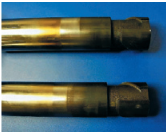
➤ Фото 2. Топливные форсунки: нижняя со следами коррозии, верхняя без коррозии
