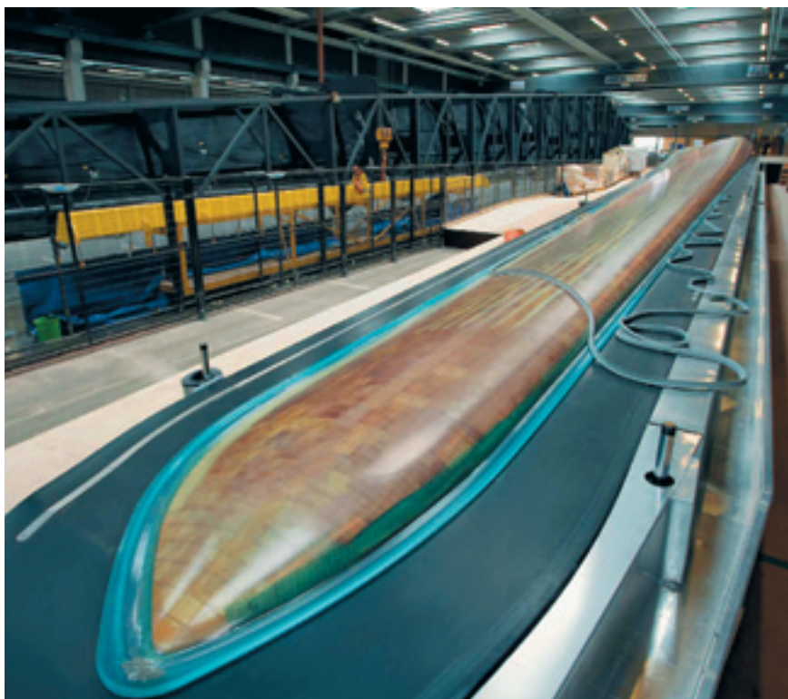
Фото. Отливка цельной лопасти турбины в г. Ольборге (Дания)
