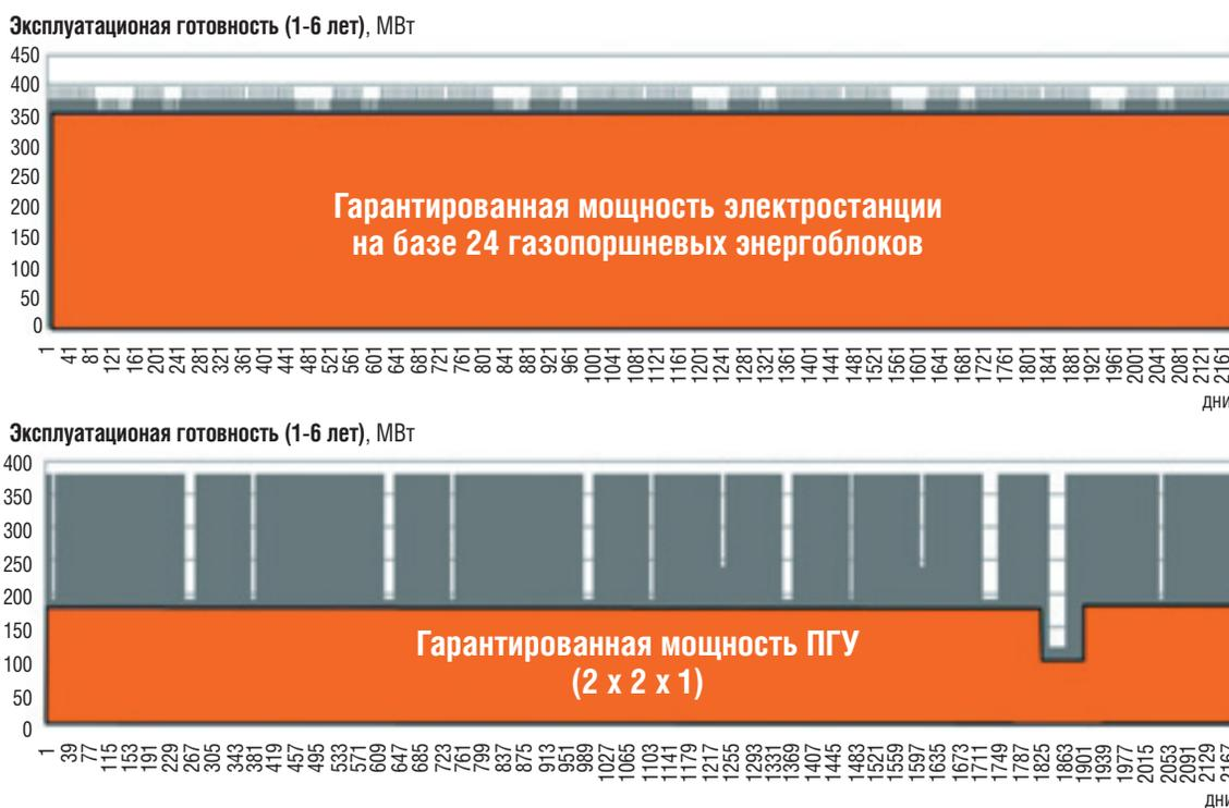
Рис. 3. Влияние многоблочной конструкции станции на готовность к эксплуатации и выдачу гарантированной мощности
