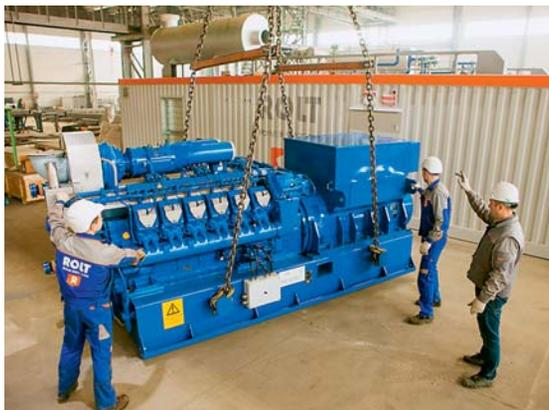
Энергетическая установка подготовлена для монтажа в составе контейнерного энергоблока
