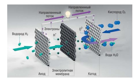
троэнергию. Такое преобразование более эффективно, чем у двигателей внутреннего сгорания, так как устраняются промежуточные термомеханические ступени, необходимые для традиционного преобразования энергии.
