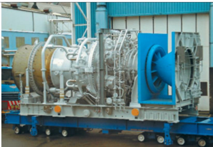
Фото. Газовая турбина MS6001FA является среднеразмерным представителем семейства двигателей Frame компании GE
