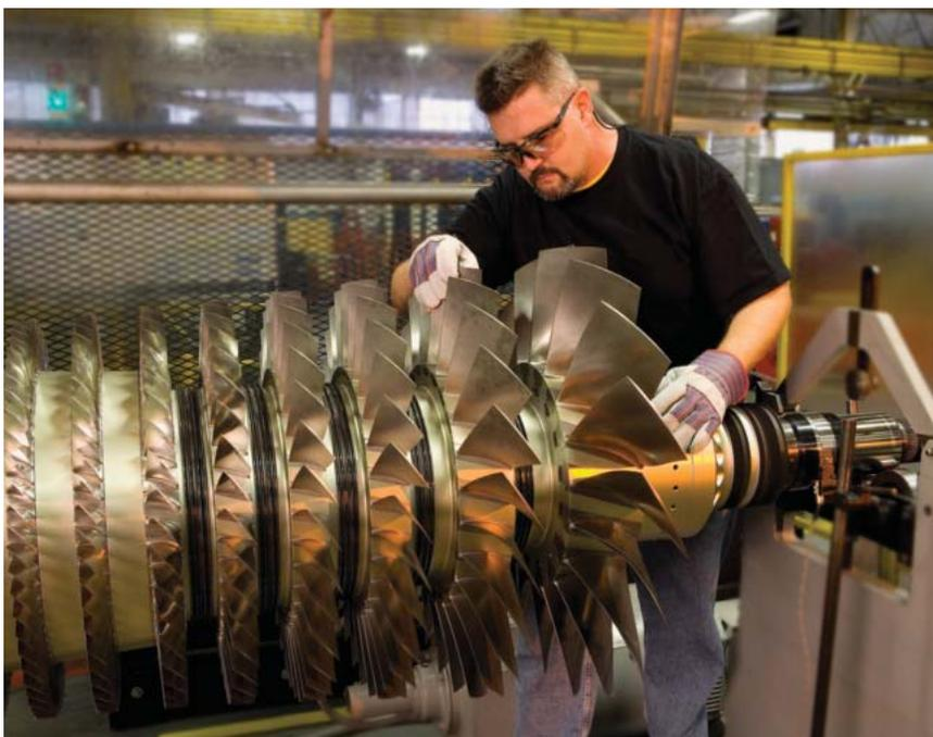
Сборка ротора газовой турбины Т25
